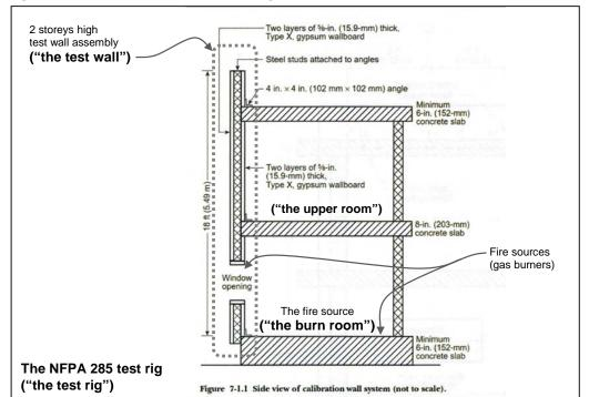
Figure 3: The NFPA 285 fire test rig<sup>16</sup>
